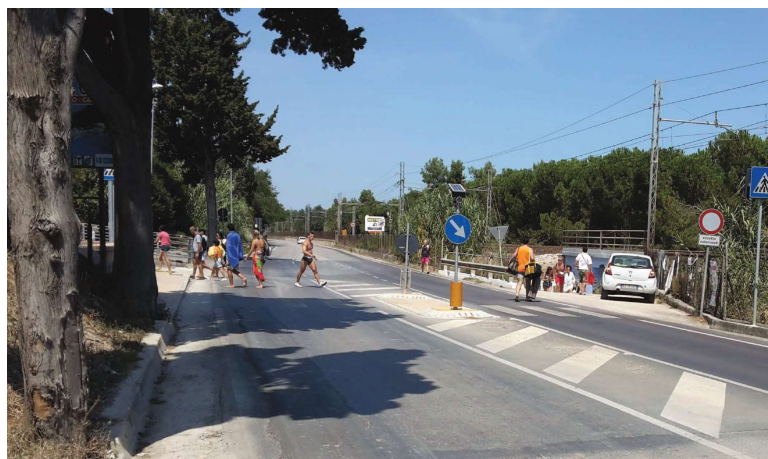
Isola spartitraffico di segnalazione come porta di città, con protezione dell' attraversamento pedonale a mare.
