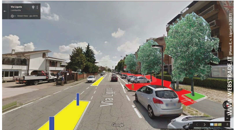
Zona 30 su una strada principale di traffico. Canalizzazione del traffico con fascia centrale polivalente sormontabile, delineati flessibili, minirotatoria, cambi di pavimentazione e trattamento ambientale del percorso
