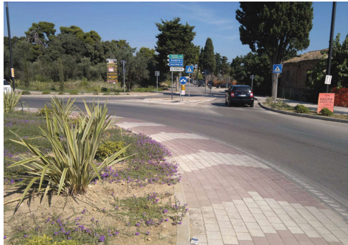
Percorso ciclopedonale con colorazione intensa, lungo una strada principale di traffico. Trattamento a verde dei bordi del percorso. Variazione orizzontale della carreggiata con sistemazione delle fermate Bus, contrapposte davanti all'attraversamento pedonale.
